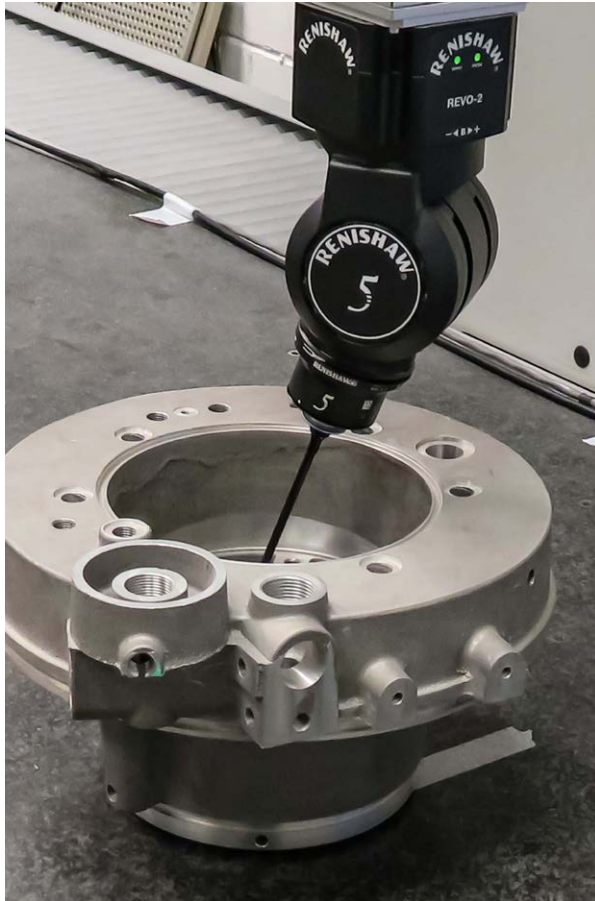
Cabezal de 5 ejes REVO con funciones de posicionamiento infinito
