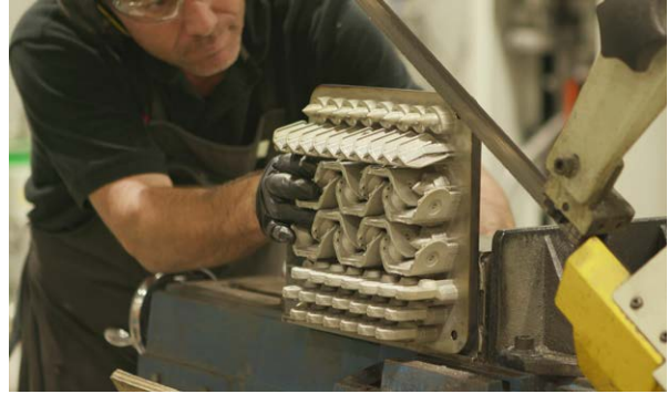
Piezas de FA en la placa de fabricación (Imagen cortesía de RAM3D)
