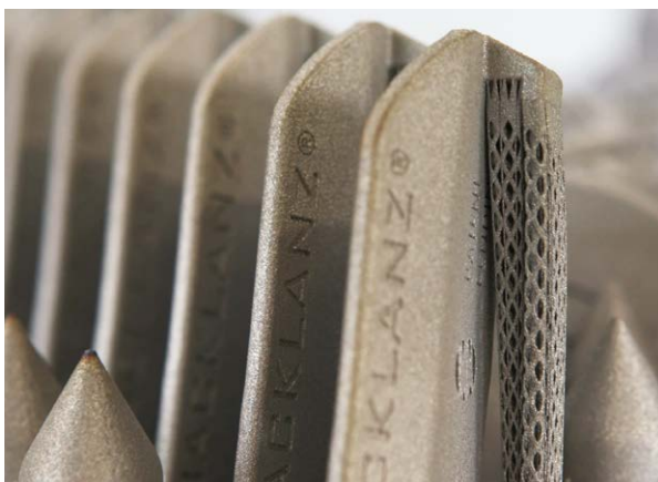
Piezas de FA fabricadas en RAM3D en una máquina AM250 de Renishaw
