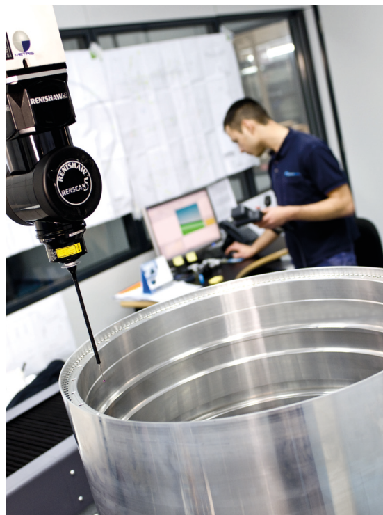
REVO skenira veliko izvrtino v komponenti za letalsko industrijo
