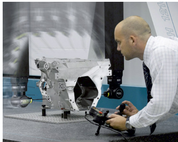
Das 5-Achsen-Scanning ermöglicht eine schnelle, reibungslose Prüfung komplexer Komponenten, ohne Pausen für Indexierungen bzw. Tastereinsatzwechsel.
