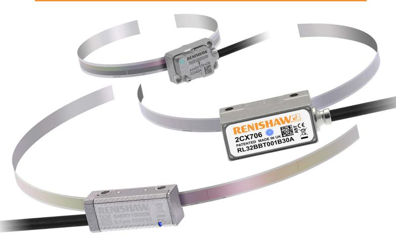
使用雷尼绍柔性RKL栅尺可轻松测量旋转运动的圆弧。这些栅尺拥有较小的横截面积,因而具有柔韧的特性,可以卷绕在半径低至26 mm的圆柱体、轴或圆弧上。
